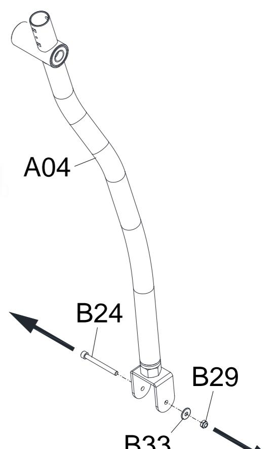
6.2 Установите Правую стойку поручня [A04] на горизонтальную ось Вертикальной стойки [A02]
