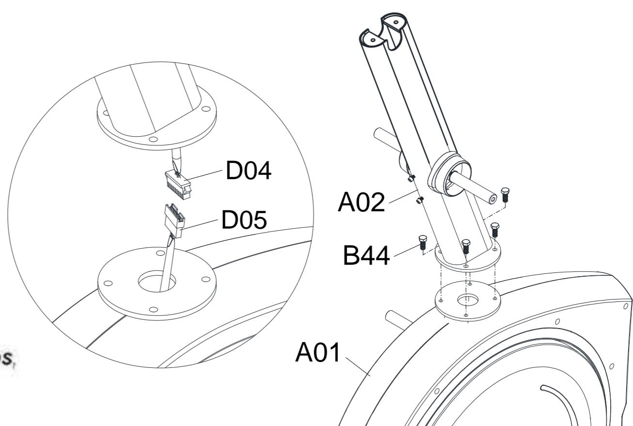
**Примечание:** Пожалуйста, не затягивайте Винты M8x20мм [B44] при помощи Шестигранной головки с отвёрткой Phillips, которая поставляется вместе с тренажёром. Это необходимо выполнять вручную.
